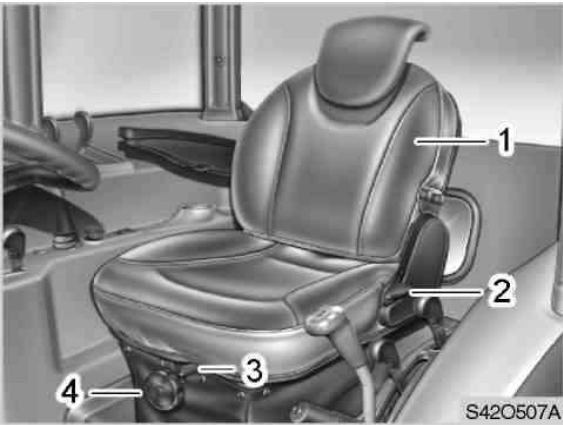
(1) Siedzisko; (2) Dźwignia regulacji pochylenia oparcia siedziska; (3) Dźwignia regulacji siedziska (przesuwanie do przodu/do tyłu); (4) Dźwignia sterowania siedziska (obciążenie poduszki siedziska)
